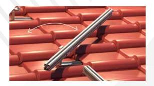
Bei der Installation der Solarmodule in horizontaler Position gelten dieselben Prinzipien wie bei der vertikalen Platzierung, mit der Ausnahme, dass das Montageprofil um 90° gedreht werden muss.
